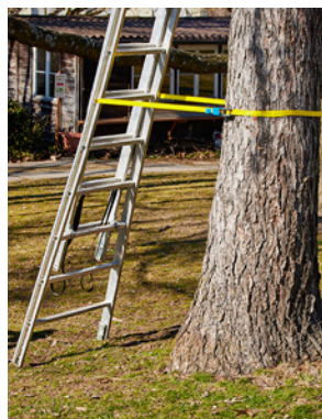
1 Sicherung der Leiter mit Spanngurt am Stammfuss
