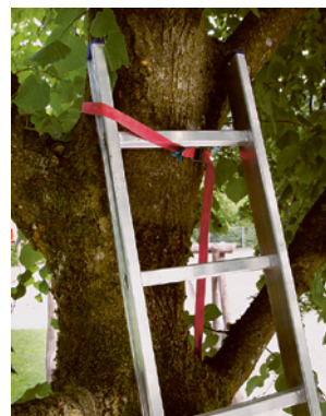
2 Sicherung der Leiter mit Spanngurt in der Baumkrone
