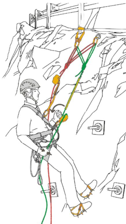
2 Systemredundanz durch unabhängige Verankerung von Arbeits- und Sicherungssystem
